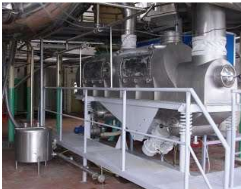
Рисунок 55. Виброаппарат для досушки и охлаждения В первой секции предусмотрена возможность напыления лецитина на слой
