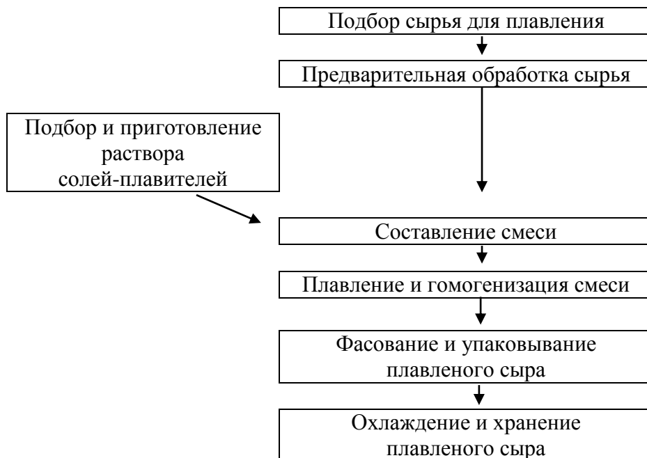
Рисунок 39. Общая схема производства плавленых сыров
