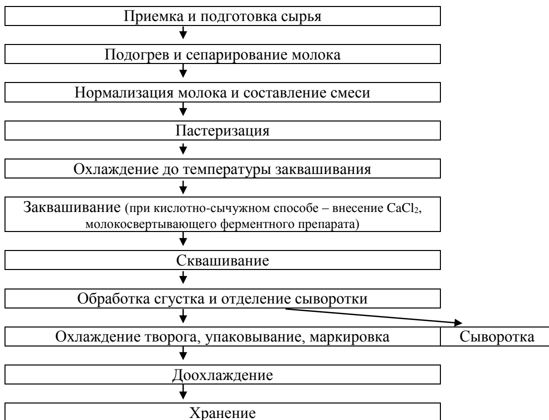
Рисунок 19. Технологическая схема производства творога
