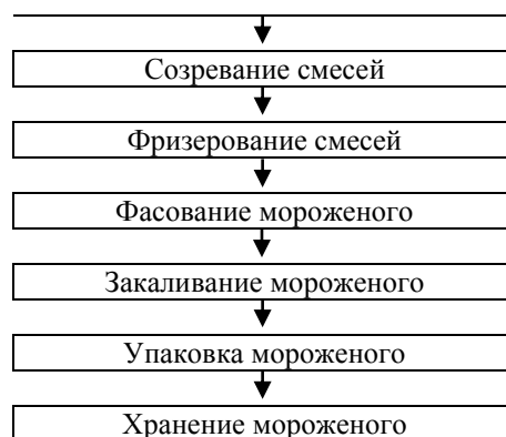
Рис. 60. Схема технологического процесса производства мороженого
