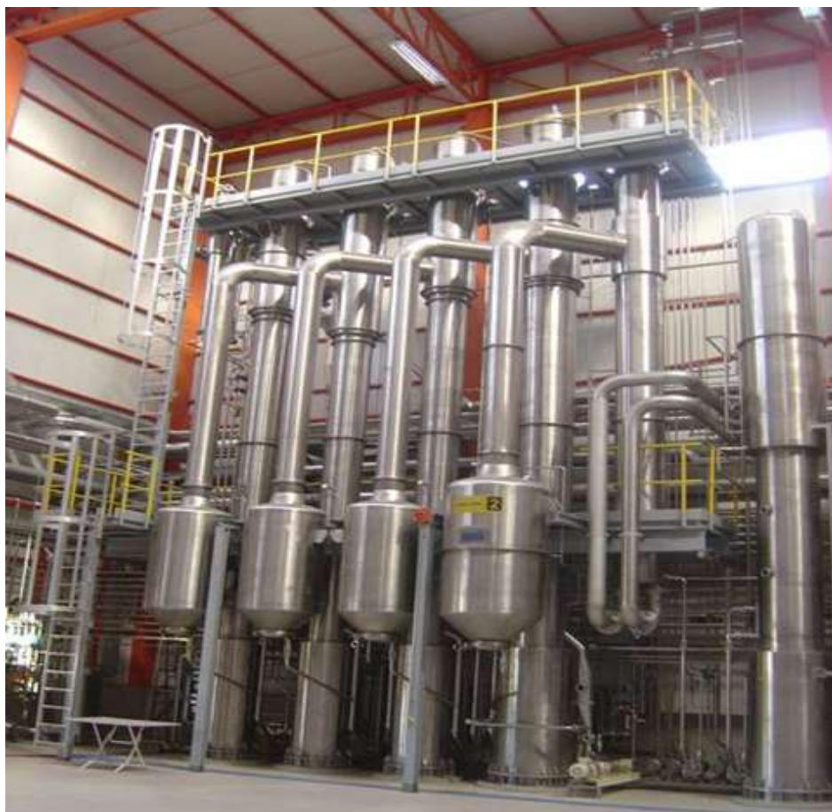
Рисунок 45. Внешний вид 4-х корпусного пленочного вакуум-выпарного аппарата с термокомпрессией пара фирмы CPS
