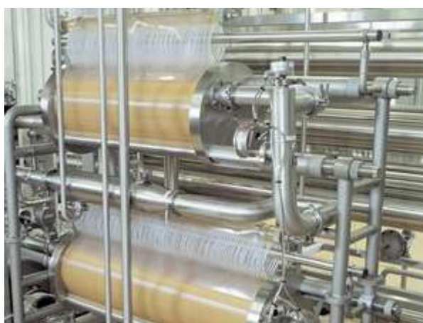
Рисунок 37. УФ-установка для использования в производстве сыров рикотта, филадельфия, маскарпоне и др.
