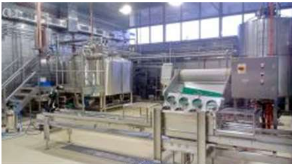
Рисунок 38. Линия по производству рокфора и камамберафирмы VPS engineering a.s.
