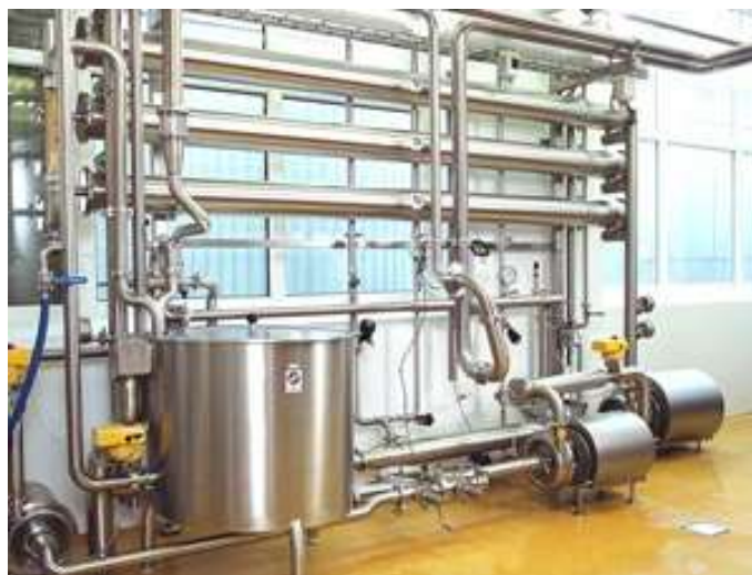
Рисунок 36. УФ-установка для использования в производстве сыра фета [46]
