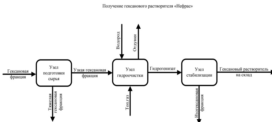
Рисунок 2.5 – Принципиальная технологическая схема получения гексанового растворителя «Нефрас»
