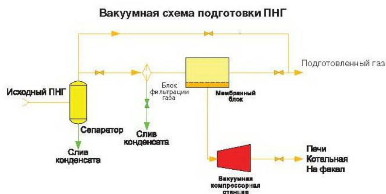
Рисунок 7.18 – Вакуумная схема мембранной подготовки ПНГ
