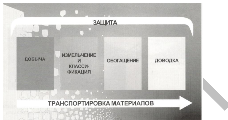
Рисунок 2.15 - Технологические этапы повышения содержания основных металлов в рудах и удаления вредных примесей
