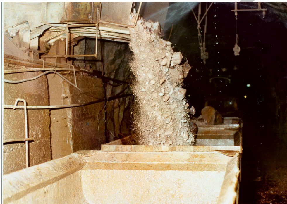
Рисунок 2.12 - Выпуск руды из блока через вибролюк
