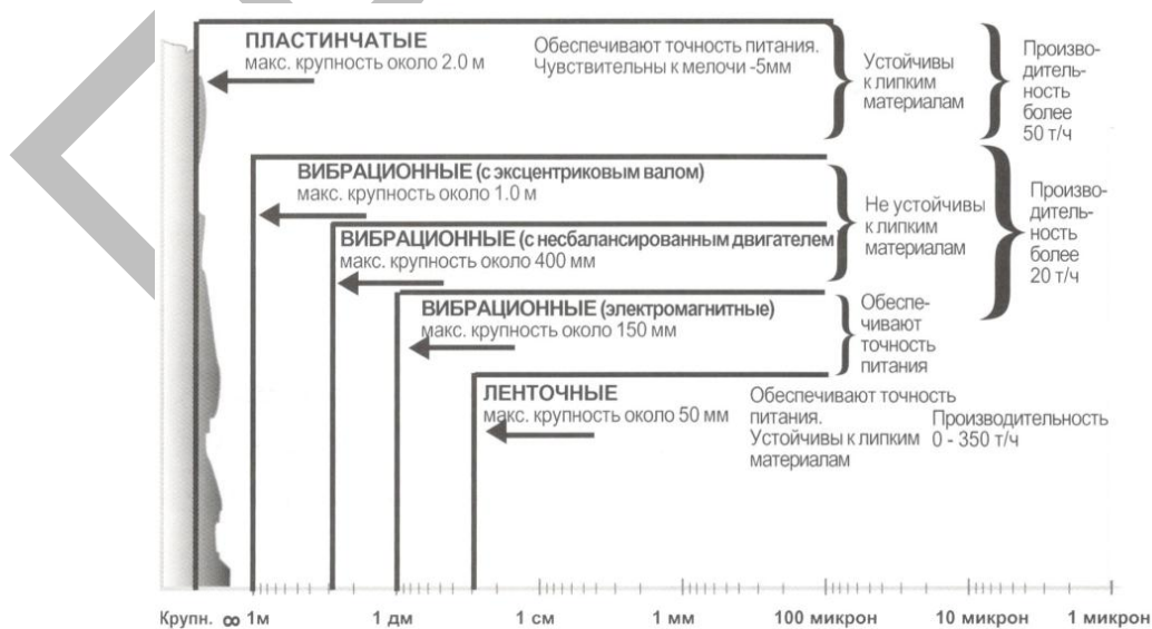
Рисунок 2.17 - Типы питателей в зависимости от крупности материала
