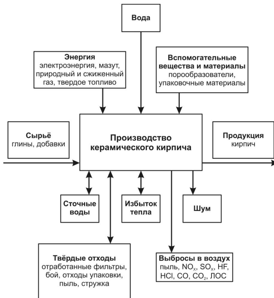
Рисунок 3.1 – Входные и выходные потоки в производстве керамического кирпича [43], с изменениями и дополнениями [49]
