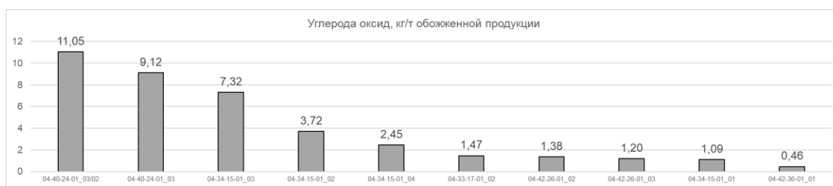
Рисунок 3.22 - Выбросы при обжиге формованных огнеупорных изделий в туннельной печи (Углерода оксид, кг/т обожженных изделий)
