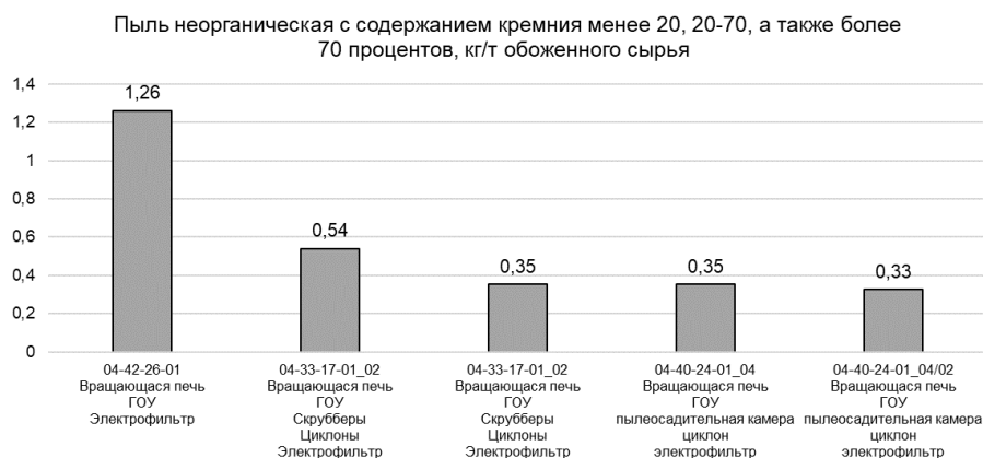
Рисунок 3.23 – Выбросы при обжиге сырья во вращающейся печи (Пыль неорганическая с содержанием кремния менее 20, 20-70, а также более 70 процентов, кг/т продукции)
