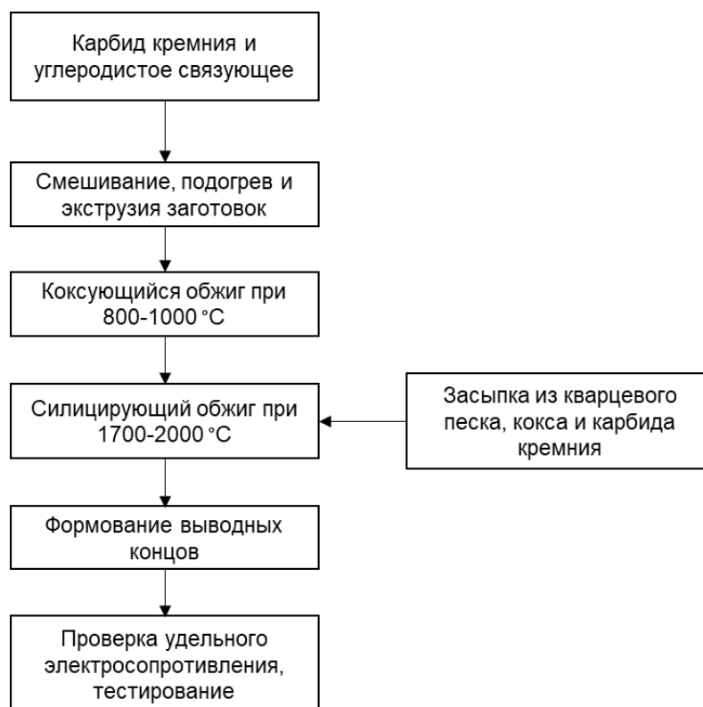
Рисунок 2.15 – Схема изготовления карбидкремниевых электронагревателей
