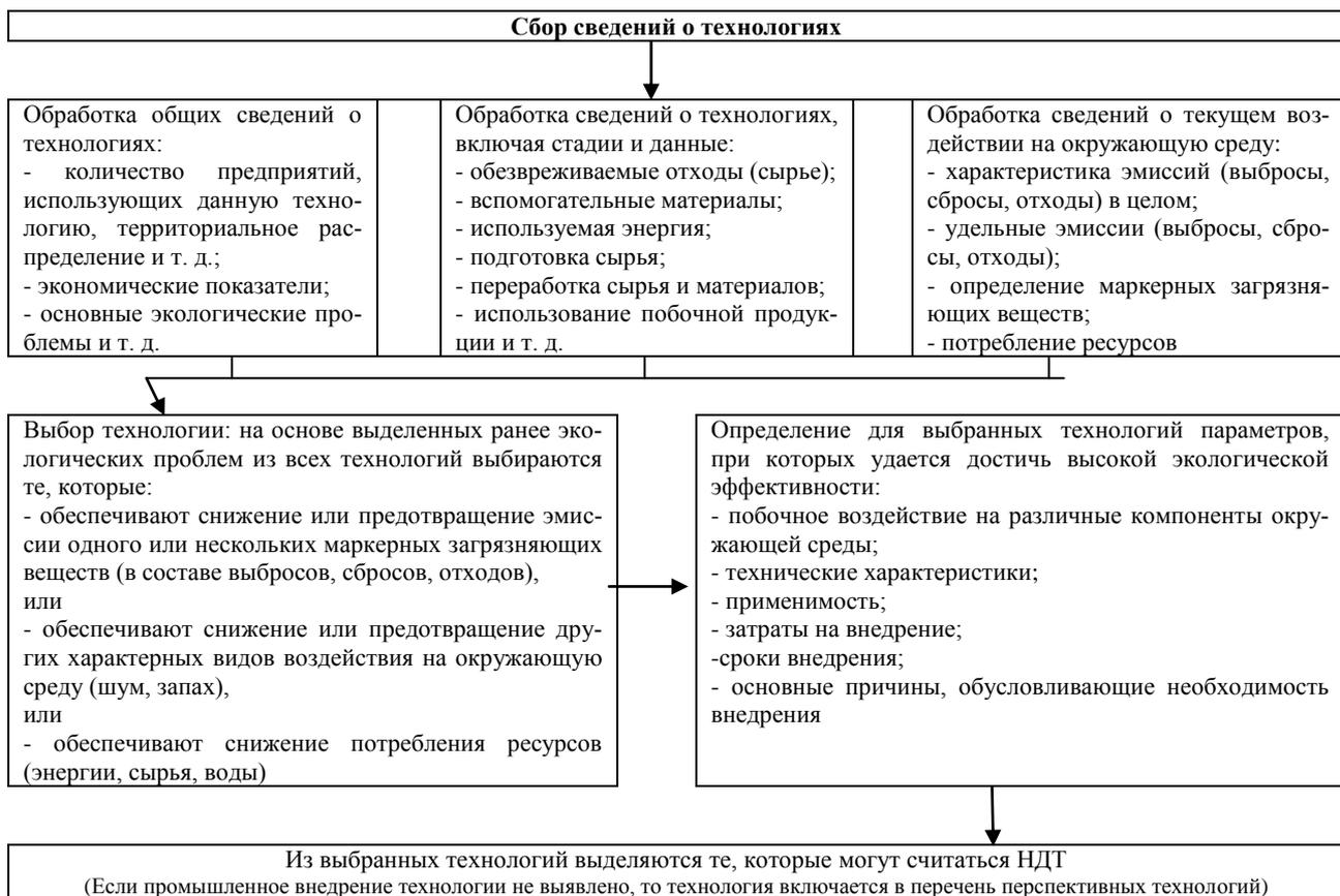
Рисунок 3.5 – Алгоритм выбора технологий, относящихся к области применения НДТ и применяемых на 2-х и более объектах в РФ, оказывающих негативное воздействие на окружающую среду.
