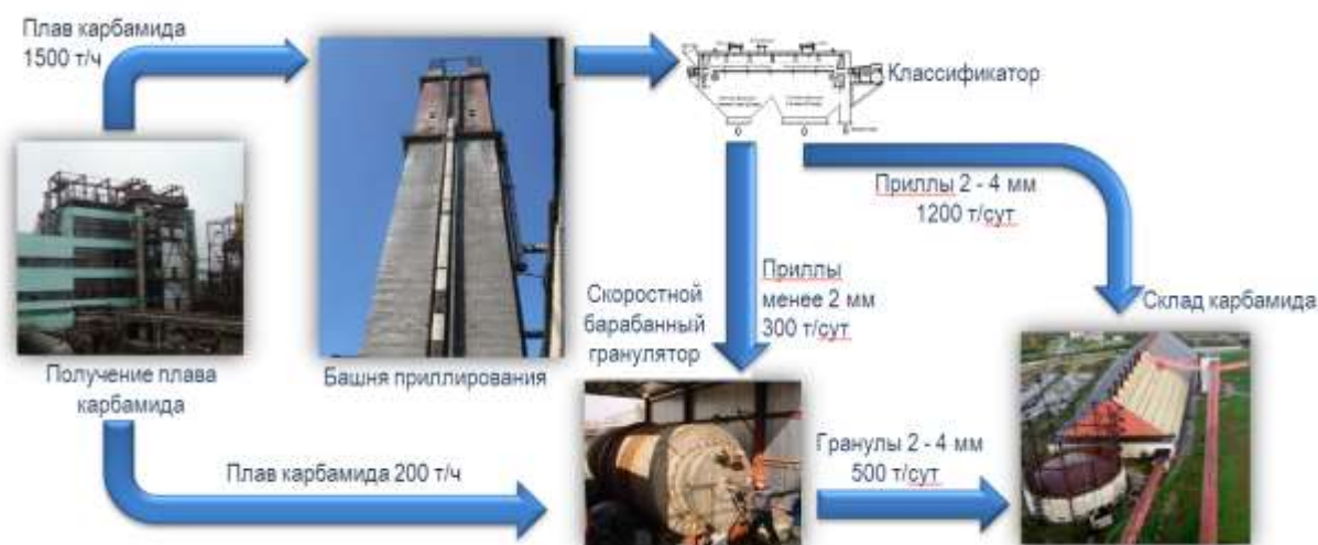
Рисунок 8.23 — Блок-схема реконструкции узла получения готового продукта с использованием СБГ
