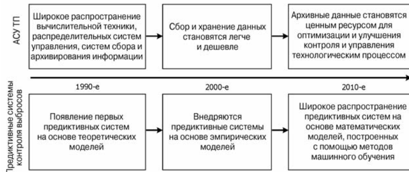
Рис. 3. Тенденции развития автоматизации технологических процессов и предиктивных систем контроля выбросов
