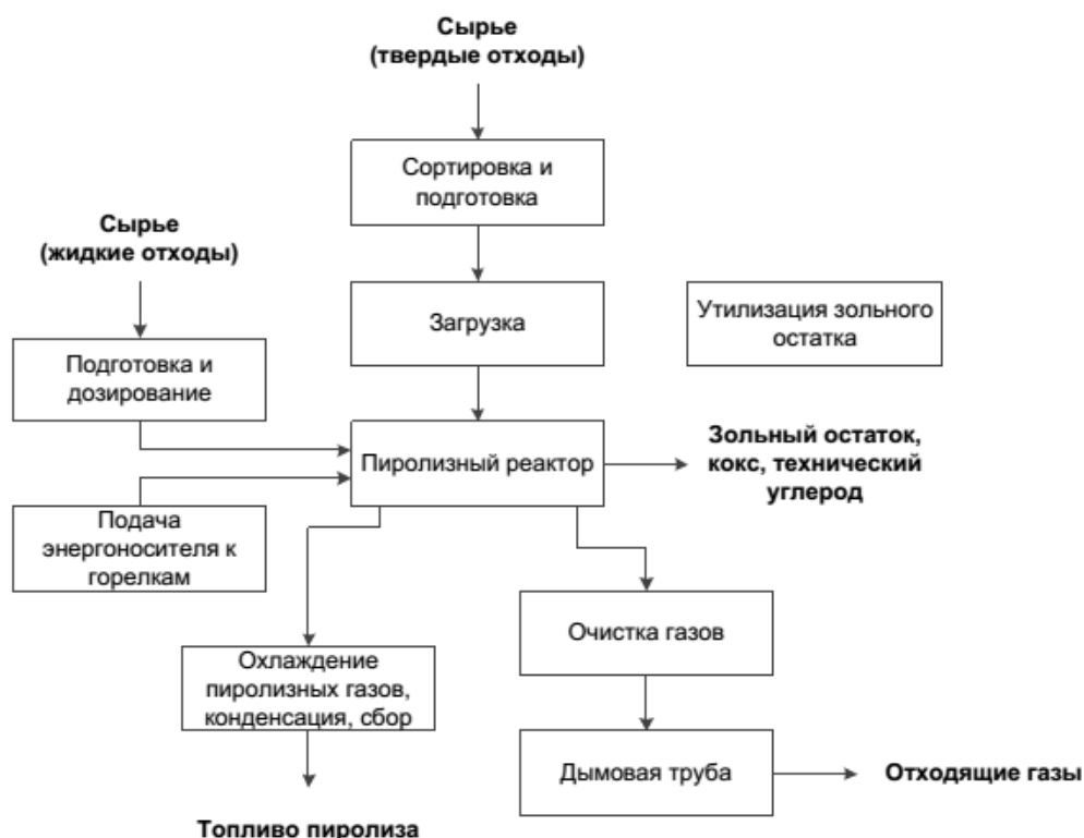
Рисунок 2.17 – Общая схема пиролиза отходов
