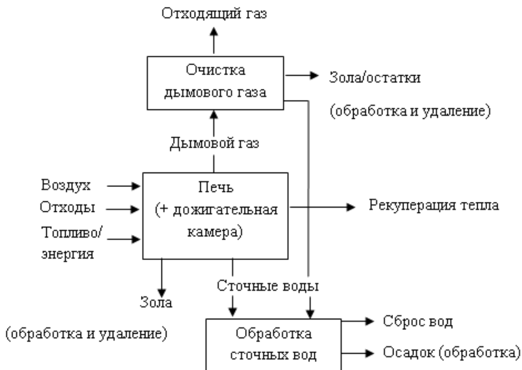
Рисунок 2.2 – Общая схема сжигания отходов с целью получения различных видов энергии
