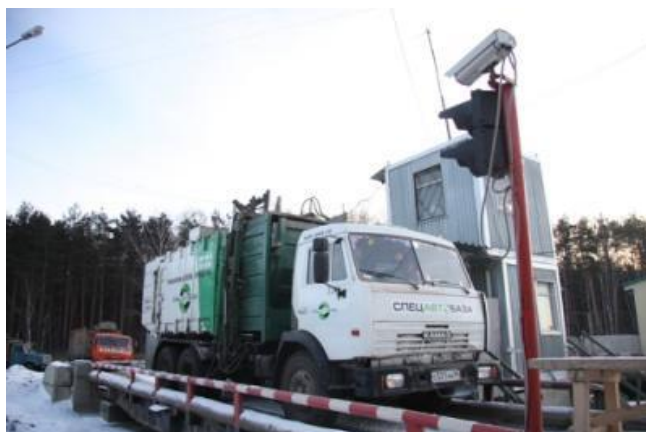
Рисунок 2.15 – Взвешивание отходов, поступающих автотранспортом, с использованием автоматизированной системы учета (Свердловская область) [48]
