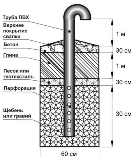
Рисунок 2.13 – Газовыпуск при устройстве траншейной системы сбора биогаза [46]
