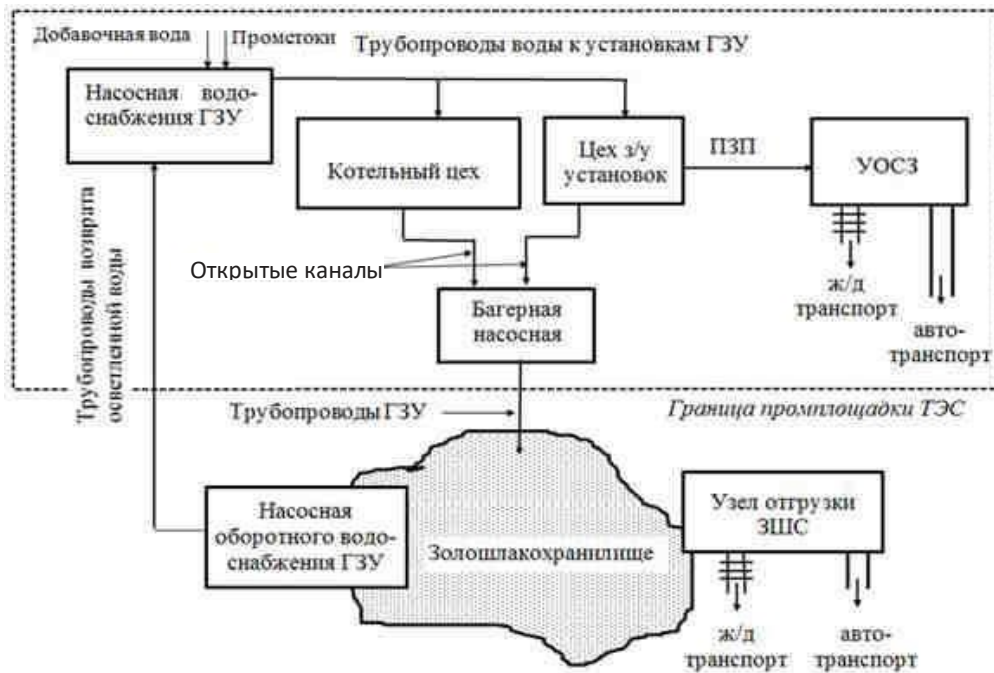
Рисунок 2.33 – Блок-схема комбинированной системы ЗШУ с отгрузкой потребителям сухой золы из УОСЗ и ЗШС из ЗШХ
